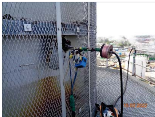
รูปที่ 3-1 การเก็บตัวอย่างคุณภาพอากาศในปล่องระบาย บริเวณ Stack HRSG21
